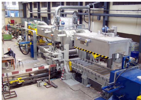
Linia walcownicza do blach stalowych produkcji Zamet Budowa Maszyn SA
