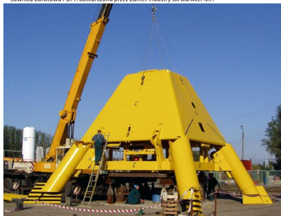
Rama PGB będąca elementem kompleksu urządzeń do podwodnego wydobycia ropy i gazu
