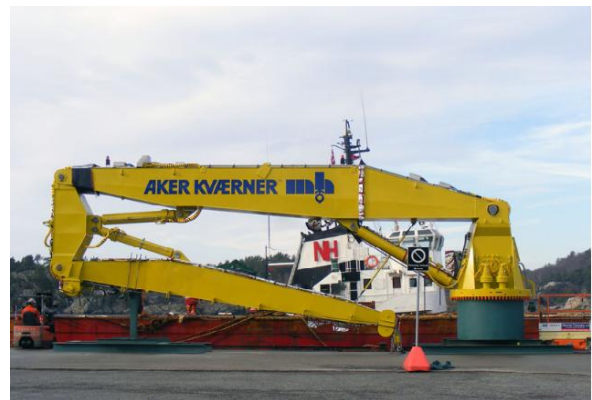
Suwica obrotowa PDPH dostarczona przez Zamet Industry SA dla Aker MH
