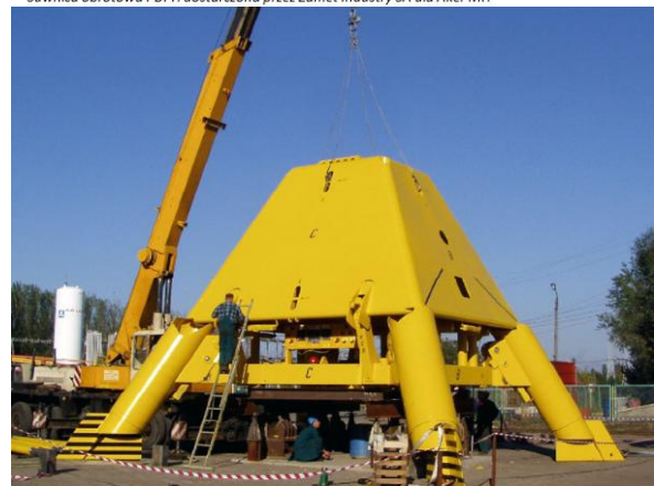
Rama PGB będąca elementem kompleksu urządzeń do podwodnego wydobycia ropy i gazu
