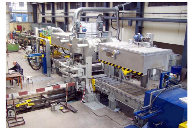
Linia walcownicza do blach stalowych produkcji Zamet Budowa Maszyn SA
