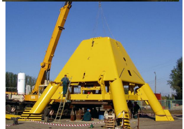
Rama PGB będąca elementem kompleksu urządzeń do podwodnego wydobycia ropy i gazu
